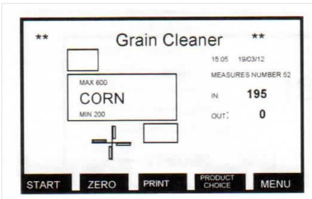
**1.2 Auswählen des Ernteguts für die Messung:** Drücken Sie die Taste „Produktauswahl“ und das Gerät zeigt die 16 Produkte auf dem Display an. Der aktuell ausgewählte Ausschnitt hat einen dunklen Hintergrund. Mit den Auf-/Ab-Pfeilen können Sie zwischen den Produkten wählen und mit der Schaltfläche „Ändern“ die Parameter ändern
