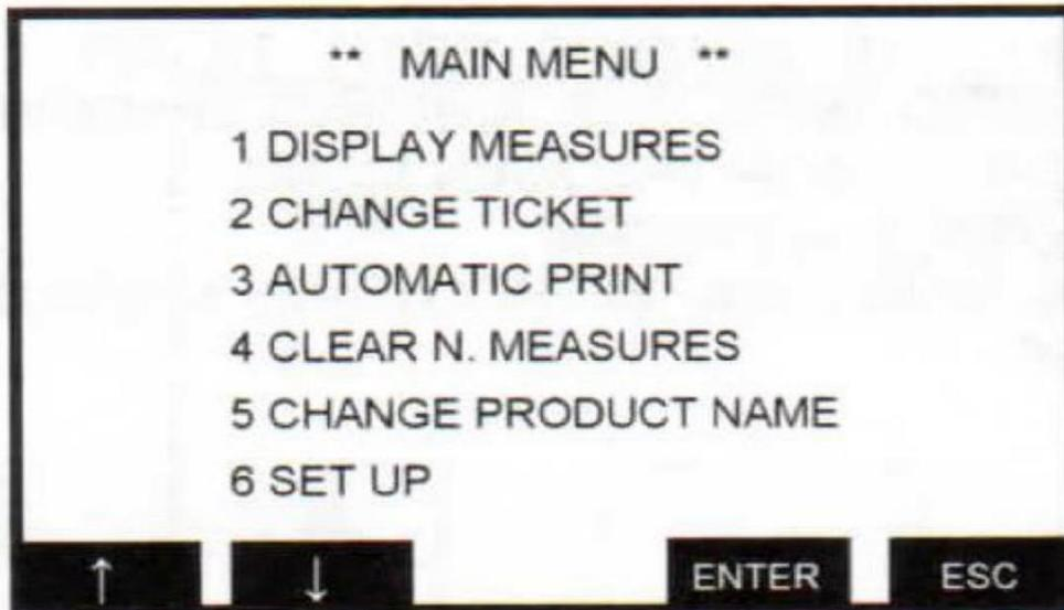
2.4 Transkribieren des Produktnamens: Wählen Sie über den Menüpunkt „Produktname ändern“ das entsprechende Produkt aus. Mit Hilfe
